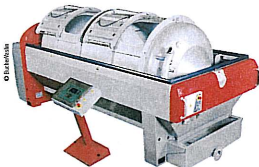
Décompression : lors des rebêchages, le gaz inerte est aspiré dans la cuve du pressoir.
